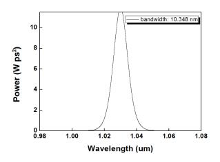
그림 2.28 펄스 압축기 통과 후 bandwidth 설계.
