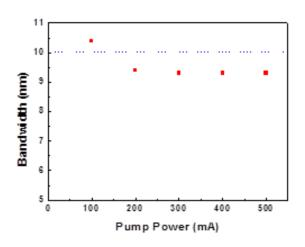
그림 4.26 펌프 LD의 Current 변화에 따른 펄스의 스펙트럼 변화 측정.
