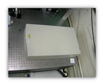
그림 3.1 Ti:sapphire 레이저.
