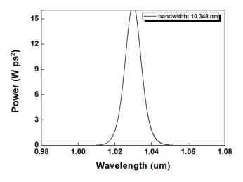
그림 2.26 광섬유 2차 증폭기 통과 후 bandwidth 설계.
