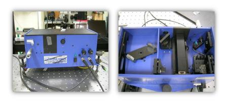
그림 3.3 ~90 ps 까지 측정가능한 Autocorrelator.
