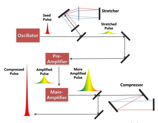
그림 2.2 펨토초 레이저를 이용한 첩 펄스 증폭 시스템 구성도.[13]
