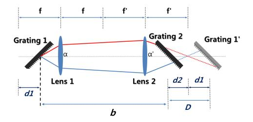
그림 2.7 회절격자 쌍과 음의 거리를 가진 망원경 구조.
