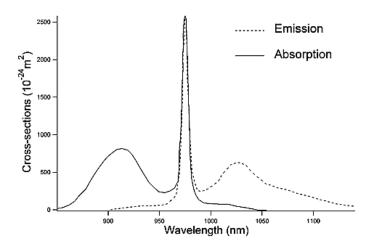
그림 2.11 Ytterbium이 첨가된 germanosilicate host에 대한 흡수 및 방출 단면적.[30]
