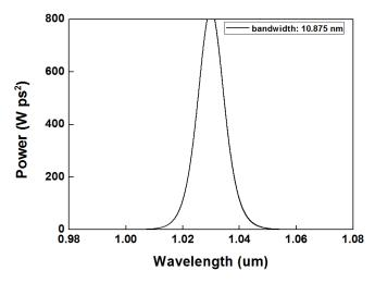
그림 2.24 광섬유 1차 증폭기 통과 후 bandwidth 설계.
