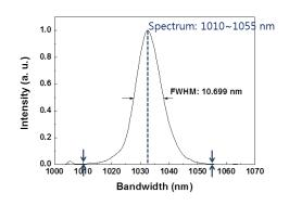
그림 4.13 Ti:sapphire 레이저의 스펙트럼.
