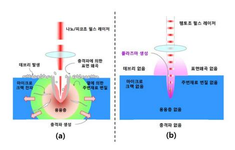
그림 1.1 (a)피코초 미만의 펄스와 펨토초 펄스를 이용한 마이크로 가공.[12]
